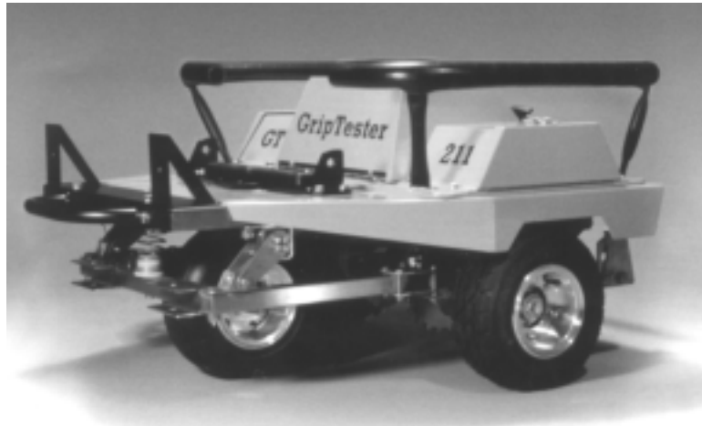
圖 3.1 Grip Tester 抗滑檢測儀[16]
